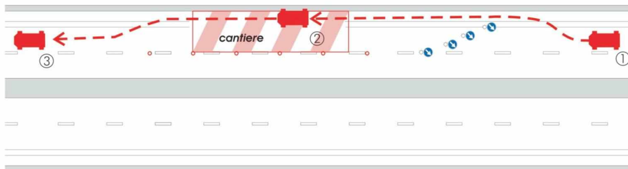
Manovra di accesso e uscita dai cantieri in caso di chiusura della prima corsia (corsia di marcia)
